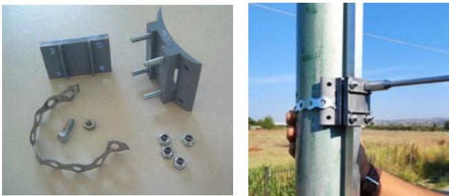
**A/A 10.** Ειδική βάση στήριξης επιστηλίου σε ιστό ή τοίχο αποτελούμενο από δύο τμήματα η κάθε μια : (α) το τμήμα στήριξης από πολυαμίδιο ημικυκλικής διατομής με κατάλληλη εγκοπή στο εμπρόσθιο μέρος για την προσαρμογή του επιστηλίου και τέσσερις γαλβανιζέ κοχλίες και (β) το τμήμα συγκράτησης του επιστηλίου από πολυαμίδιο, το οποίο θα φέρει τέσσερις οπές και θα προσαρμόζεται στο τμήμα στήριξης με τέσσερα μπουλόνια.
