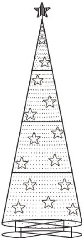
**A/A 14.** Φωτεινό σώμα (**ΤΡΙΣΔΙΑΣΤΑΤΟ ΔΕΝΤΡΟ ΥΨΟΥΣ 7,00M**) ύψους 7,00m, πλάτος 2,25m . Η όλη κατασκευή δε θα ξεπερνά τα 310W.
