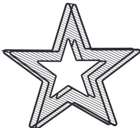
**A/A 13.** Φωτεινό σώμα ( **ΕΠΙΔΑΠΕΔΙΟ ΑΣΤΡΟ 1,80Μ** ) διαστάσεων 1,80mx 1,80m. Η όλη κατασκευή δε θα ξεπερνά τα 185W. Αποτελούμενο από σκελετό αλουμινίου στέρεα συγκολλημένου με καλαίσθητες ενώσεις πάνω στον οποίο δένεται μονοκάναλος εύκαμπτος φωτοσωλήνας και λυχνίες LED.
